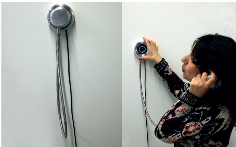
Vandalsäker hörlur i metall. Basen är fastskruvad i väggen och luren vilar i basen med kraftig magnet. Foto: Per Björklund.
