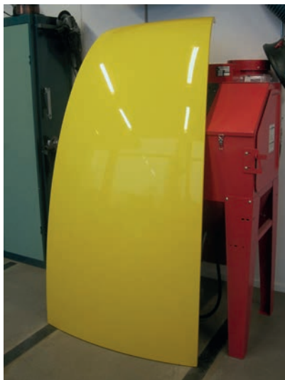
Ett färdigt väggelement. Foto: Mathias Strömer.
