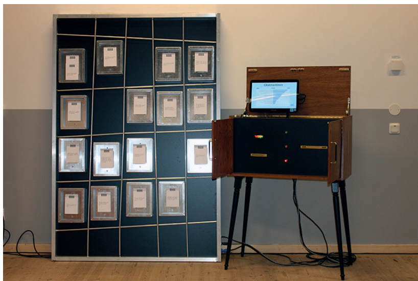
Station i Alla människor! - om rättigheter och lika värde . Barngrupper väljer citat från från LED-belysta notisblock som har monterats på en gallervägg. En "allt-i-ett" dator registrerar röster via en USB-streckkodsläsare och sammanställer dessa i en databas. Termoskrivare, kopplade via USB till datorn, skriver ut framröstat citat på plastarmband samtidigt som en radio spelar upp barnröst med samma citat. Foto: Per Björklund.
